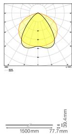
Technische Daten Ledvance LED Tragschiene Trusys Flex Klar Stahl Weiß 70W 12100lm 90D - 840 Kaltweiß | 3 Stunden Notbeleuchtung
