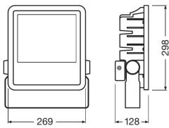
**Technische Daten Ledvance LED Flutlicht 150W 6500K 15000lm IP65 Schwarz | Symmetrisch - Ersetzt 400W**
