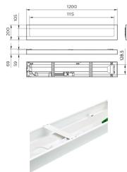
Technische Daten Philips LED Panel CoreLine SM136V 25/34W 3100-4300lm - 840 Kaltweiß | 120x20cm - UGR <19 - Dali Dimmbar - Wählbare Wattzahl - 3 Stunden Notbeleuchtung -W5
